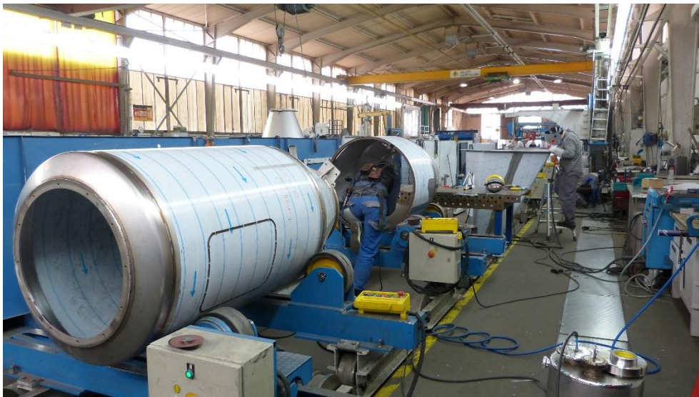
Abbildung 7: WIG-Schweißen im Innenraum eines Edelstahlbehälters
