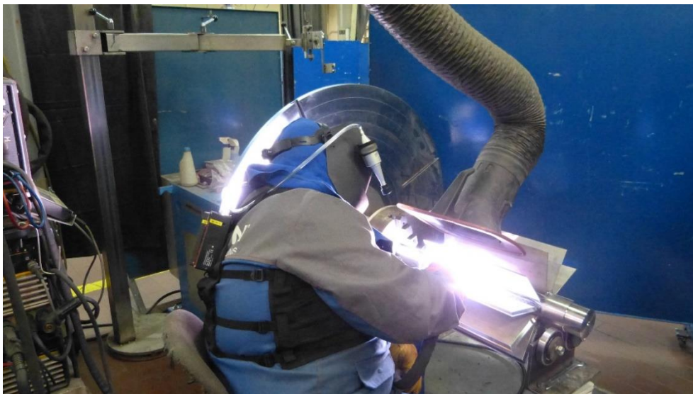
Abbildung 6: WIG-Schweißarbeitsplatz mit gut positionierter Absaugung
