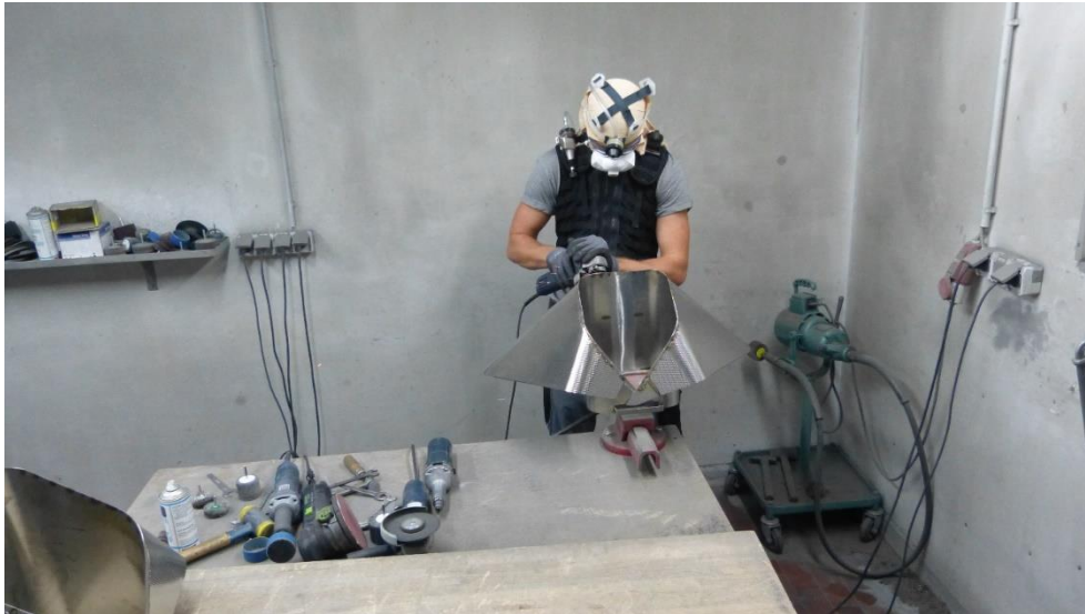
Abbildung 14: Arbeiten mit Winkelschleifer zum Glätten und Entgraten
