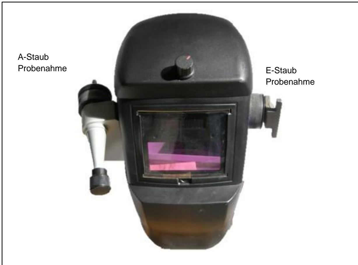
Abbildung 1: Präparierter Automatikschweißhelm mit A- und E-Staub-Probenahmekopf
