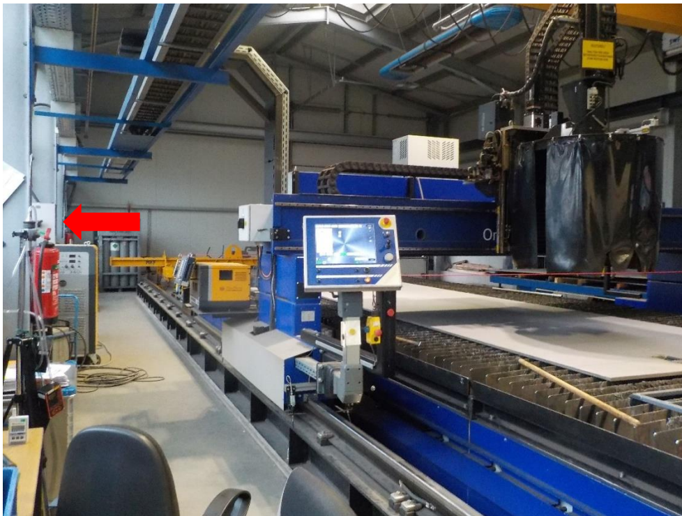
Abbildung 11: Plasmaschneidanlage mit personenbeziehbarer stationärer Probenahme (siehe Pfeil)
