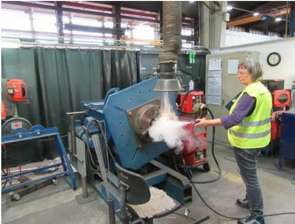
Abbildung 16: Überprüfung eines Absaugarmes auf seine Wirksamkeit mit einem Nebelgenerator
