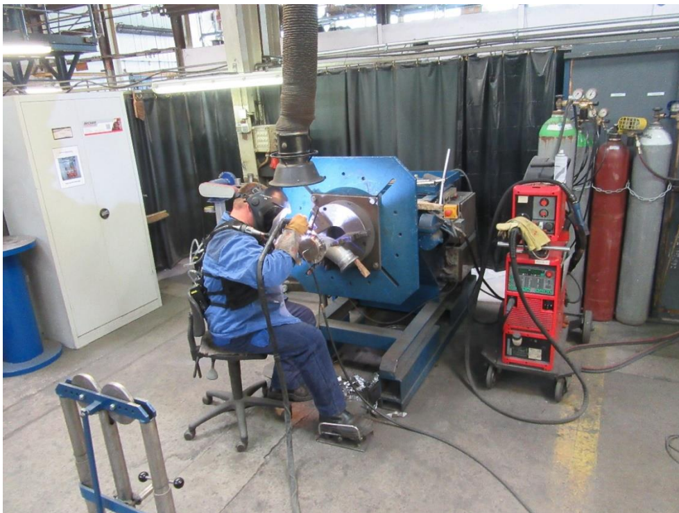
Abbildung 18: Schweißarbeitsplatz mit Drehvorrichtung zum Einspannen des Werkstücks, Steuerung der Vorrichtung mit Fußschalter
