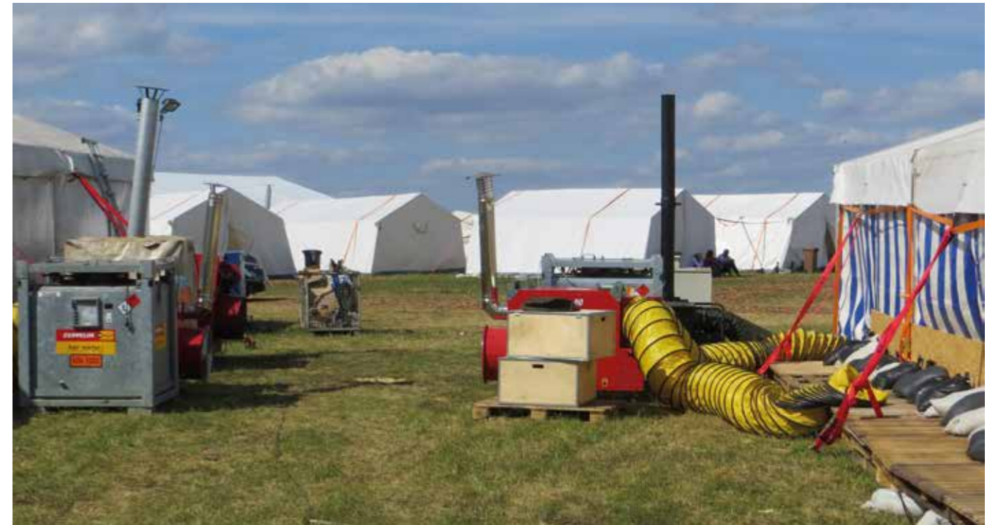
Impressionen der ersten Monate: Dieselbetriebene Heizaggregate bliesen warme Luft in die Zelte. Sandsäcke und Spanngurte schützten die Zeltplanen vor dem zeitweise kräftigen Wind auf dem alten Flugplatzgelände. Die Arbeitsbedingungen der Helfer und die Lebensbedingungen der Geflüchteten waren mit »herausfordernd« unzureichend beschrieben. Foto: RP
